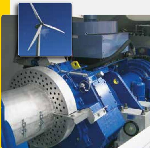
Easy-Laser® viene usato per allineare generatori e riduttori in turbine eoliche di varie dimensioni e modelli. Sono disponibili staffe speciali per l'allineamento con rotori fissi, in grado di incrementare la sicurezza per l'operatore.
