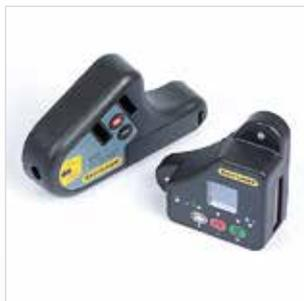
E180 BTA. Trasmettitore e sensore wireless Bluetooth® laser per l'allineamento delle trasmissioni a cinghia. Con display integrato. Utilizzarlo come strumento separato o collegarlo a E710 per funzionalità estese. Codice 12-0796
