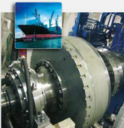
Motori, riduttori e alberi di trasmissione presenti sulle navi vengono allineati usando il sistema Easy-Laser®. Grazie alle staffe flessibili è possibile installare l'apparecchiatura nel luogo più appropriato: l'albero, il giunto o il volano.
