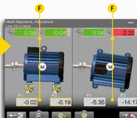
1. Immettere le distanze tra le unità di misurazione e i piedi della macchina. Immettendo il diametro del giunto è inoltre possibile ottenere il risultato come distanza/flessione.
